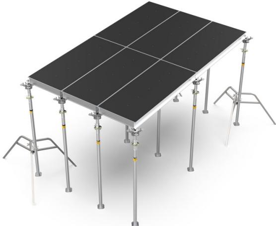
El sistema de encofrados SINIS DECK es un sistema panelizado para el apuntalamiento económico y seguro de las losas. Se compone de sólo dos componentes básicos: panel y puntales. El panel enmarcado de aluminio es ligero y práctico. La hoja de alto rendimiento está protegida por perfiles especiales de marco en todos los bordes y diseñada para un alto número de reutilizaciones. Los puntales metálicos Pep 20KN se pueden utilizar con el encofrado SINIS DECK..
