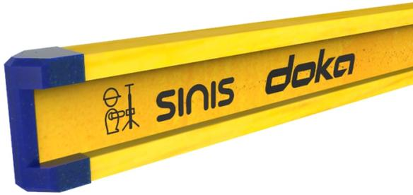
Viga de alma sólida de madera o de materiales derivados de la madera según la EN 13377. Las alas son de madera abeto automáticamente clasificadas y el 100 % de las alas de las vigas se ensayan con el método de carga de tracción. Alma de tablero aglomerado especial. Refuerzo de los extremos de poliuretano.
