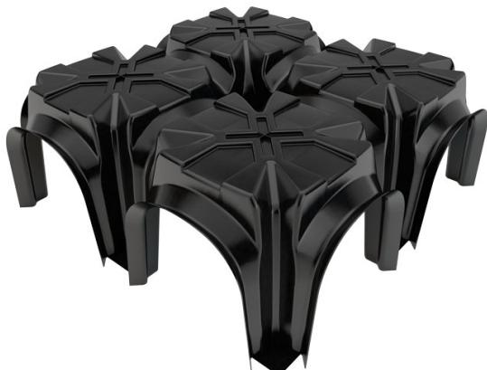
Multimodulo se origina de la experiencia de Geoplast en la producción de encofrados perdidos para la construcción de forjados sanitarios ventilados: este elemento une cuatro elementos Modulo en un único elemento, proporcionando altos estándares de capacidad de carga tanto durante la instalación como durante el hormigonado gracias a nueve soportes por cada elemento..
